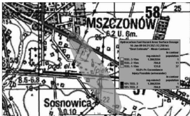
Rys. 1. Strefy skażeń powstałe w wyniku wycieku etyliny z cysterny w terenie luźno zabudowanym - warunki zimowe. Prognoza wykonana przy użyciu programu komputerowego H-PAC [5,19]
