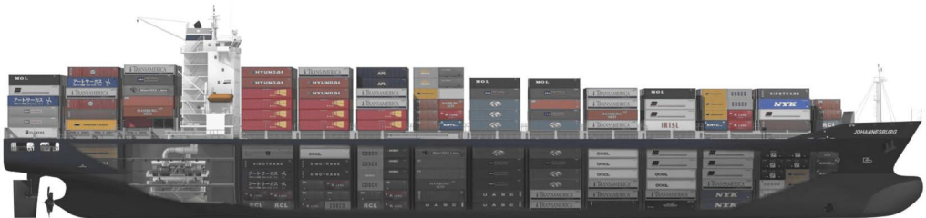
Rys 62. Widok na ładownię oraz przekrój wzdłużny kontenerowca.
