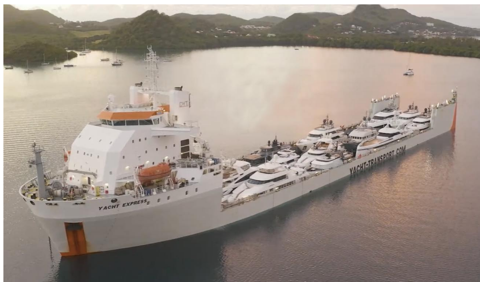
Rys. 15. Proces przewozowy jachtów morskich barkowcem tyłu float on – float off.
