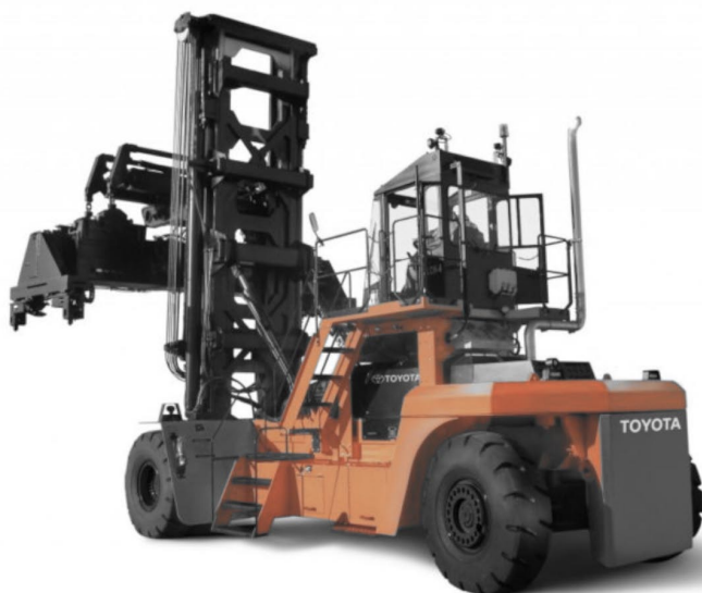
Wózek do manipulowania pełnymi kontenerami ( Full Container Handler – ECH )
