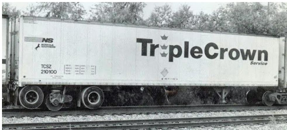
Rys. 7. Podsystem bimodalny transportu intermodalnego Roadtrailer Mark IV w 1978 r.
