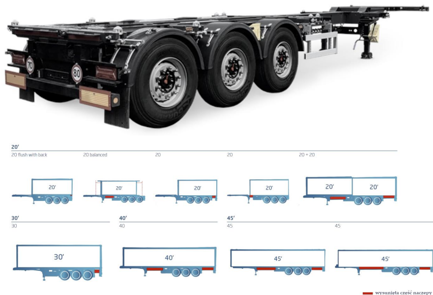
Rys. 58. Naczepa kontenerowa firmy Wielton oraz możliwości konfiguracji jej długości.
