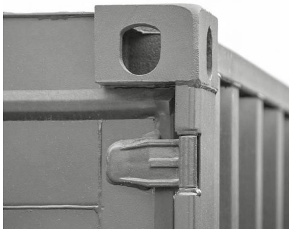
Rys. 4. Naroże zaczepowe kontenera wynaleziony i opatentowany przez Malcolma Mcleana.
