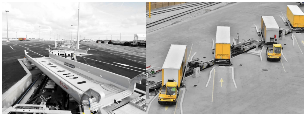
Rys. 55. Wagony w terminalu przeładunkowym oraz proces załadunku naczep ciężarowych w podsystemie Modalohr.
