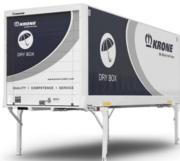
Rys. 48. Nadwozie wymienne rodzaju C, z systemem BDF firmy Krone.
