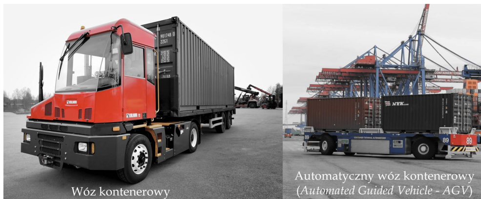
Rys. 43. Wóz kontenerowy oraz automatyczny wóz kontenerowy ( Automated Guided Vehicle – AGV ).
