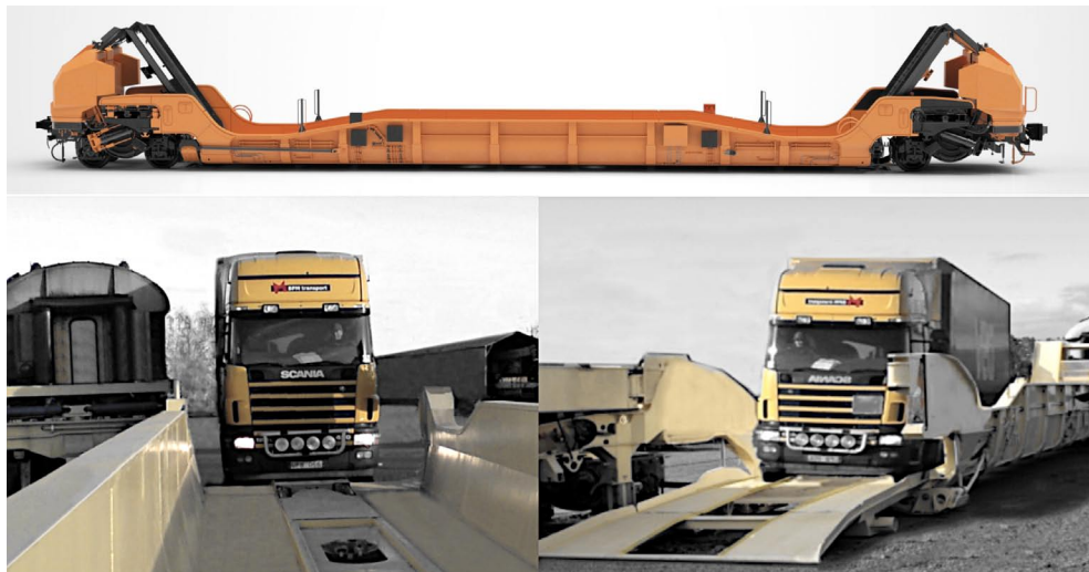
Rys. 56. Wagon podsystemu Flexiwaggon oraz jego załadunku i rozładunku.
