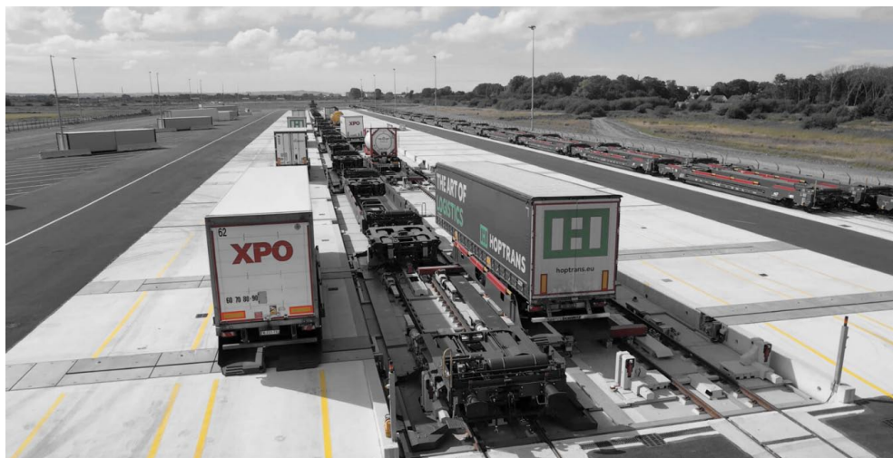
Rys. 57. Podsystem CargoBeamer podczas jednoczesnego rozładunku i załadunku naczep.
