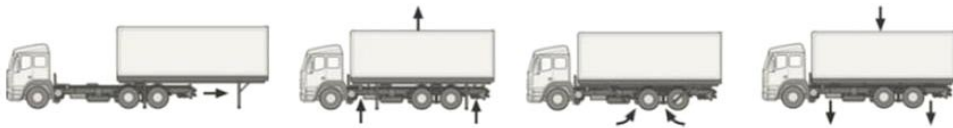
Rys. 11. Proces przeładunku nadwozia wymiennego w transporcie samochodowym.
