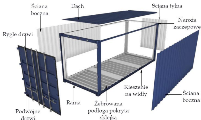
Rys. 46. Uproszczona budowa kontenera ISO.
